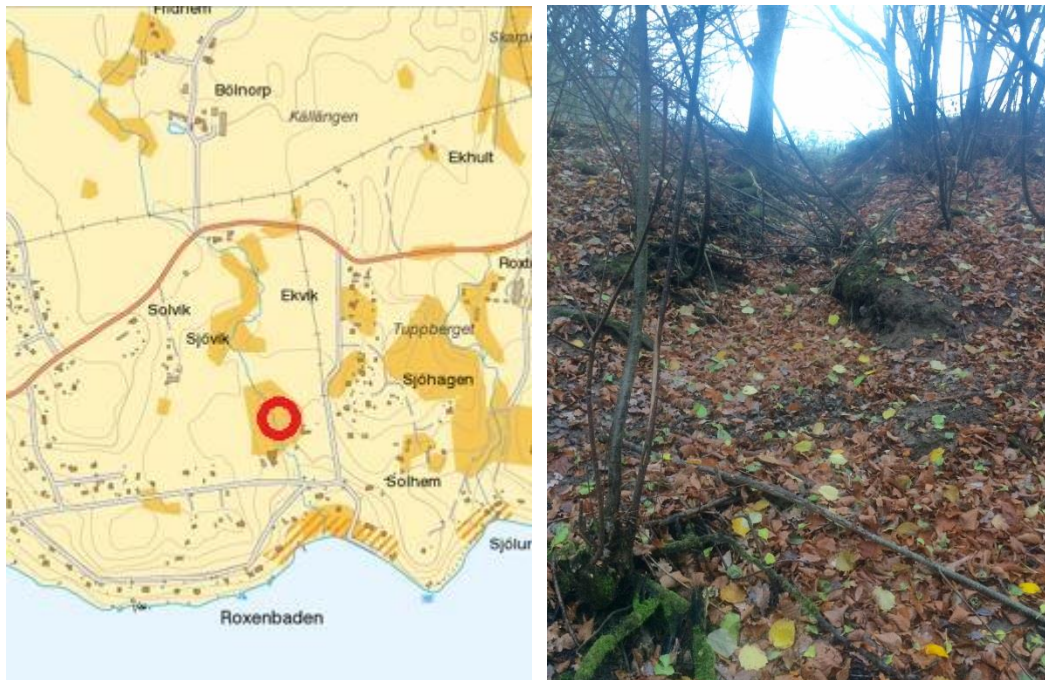
Fig 7. Utdrag från SGU-kartan avseende skredrisker i finkorniga jordarter. Till höger syns erosion i bäckravinen. Området är markerat med röd ring i kartan.
