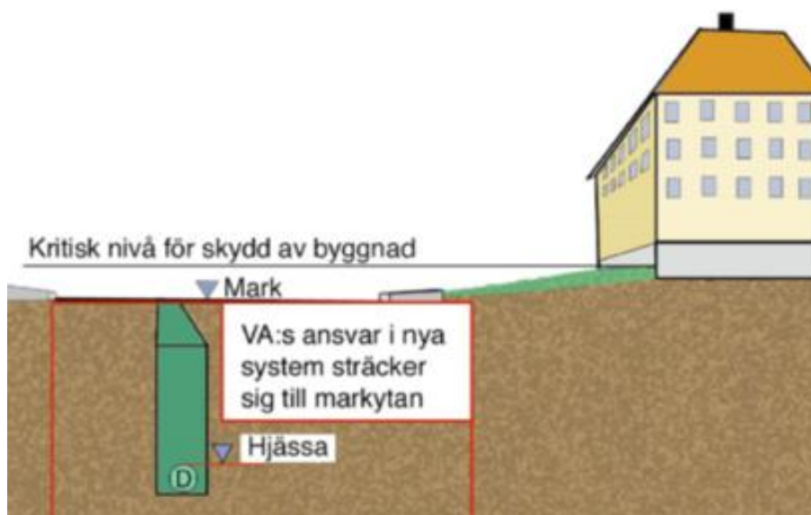
Figur 10 Höjdsättningsprincip för nya byggnader för skydd mot översvämningar (Svenskt Vatten P110)
