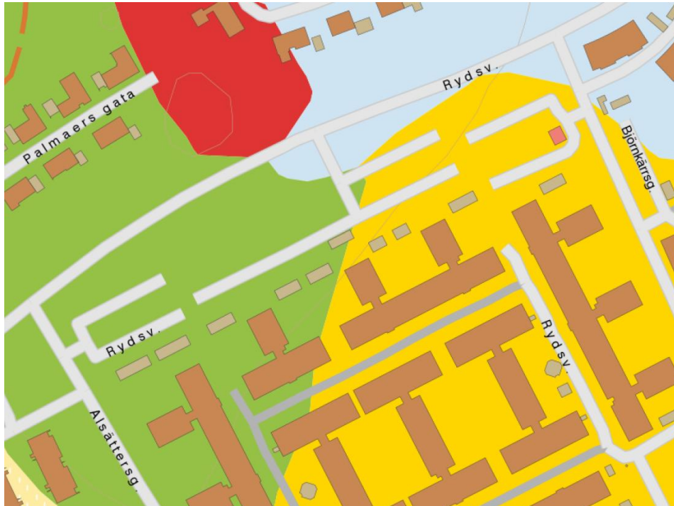
Figur 7 Jordartskarta, gult markerar glacial lera, blått sandig morän, grönt isälvssediment och rött är berg. (© Sveriges geologiska undersökning)
