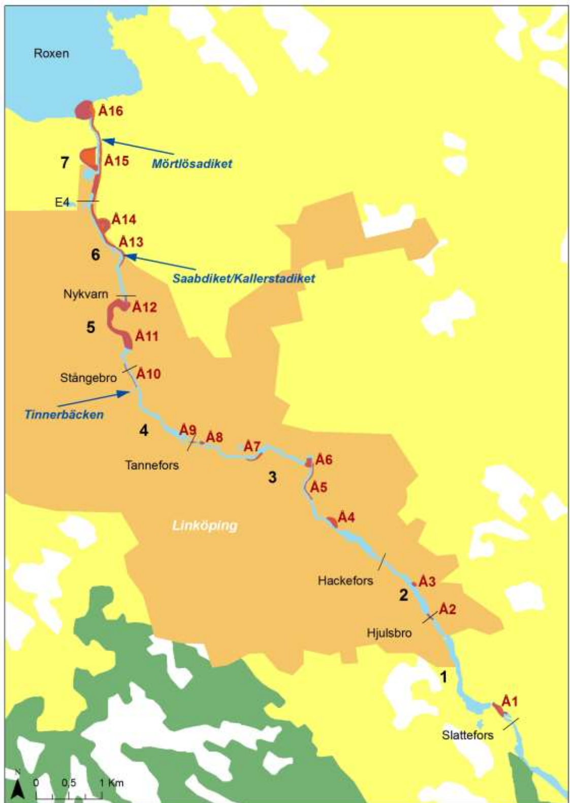
Figur 2. Översikt över samtliga åtgärdsområden. Numreringen för åtgärdsområdena (Å1-16) visas i röd text på östra sidan om Stångån. Delsträckornas numrering (1-7) visas i svart på västra sidan om ån.
