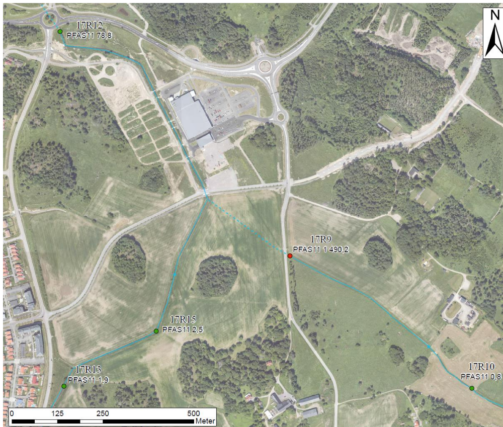
Figur 7. Lokalisering ytvattenprov. Vid 17R12, 17R13 och 17R15 uttogs i föreliggande provtagning sedimentprover (Ramböll, 2018a). Rött = halter över 900 ng/l, gul = halter över 90 ng/l, grön = halter under 90 ng/l.
