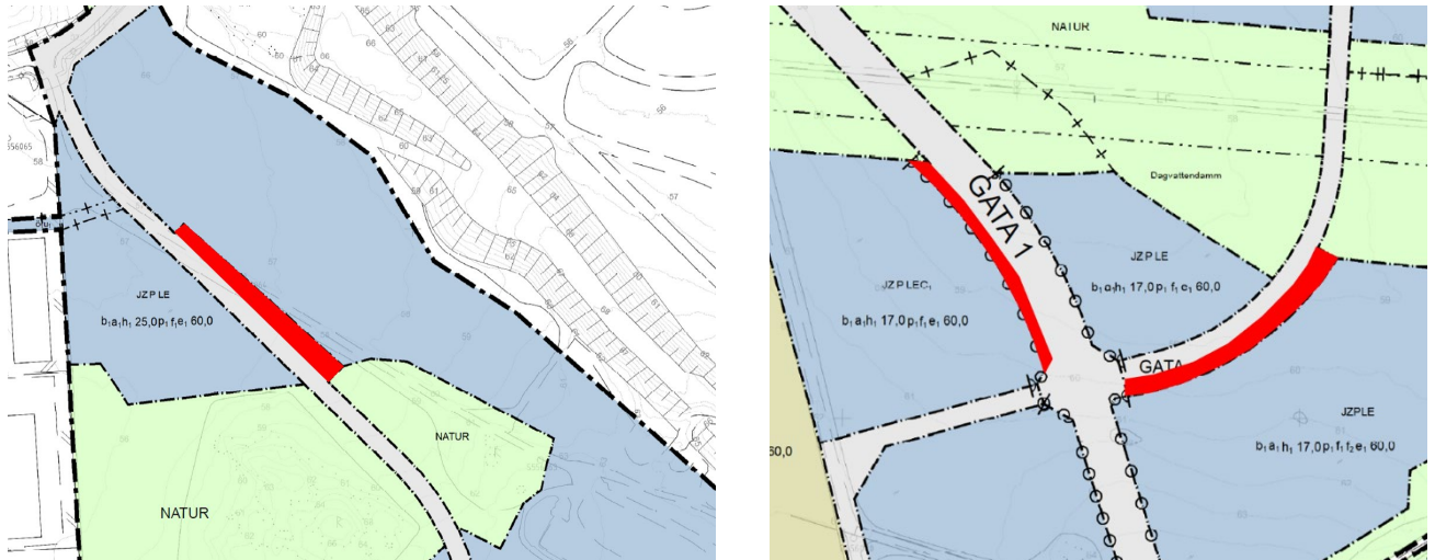
Bild: Till vänster, yta i norr där gatuområdet har breddats (rött), och bild till höger ytor i söder där gatuområdet har breddats (rött) för att inrymma dagvattendike.
