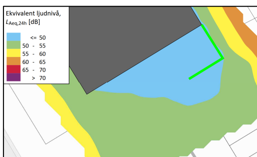
Figur 9. Exempel på avskärmning av gemensam uteplats i kvarter 5 (riktvärdet för maximal ljudnivå klaras utan skärmar, se Bilaga A02).
