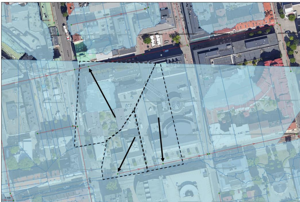
Figur 10. Utklipp från skyfallsmodellen (Ramboll, 2022). Avrinningsområden (streckade polygoner) beskriver hur vatten från planområdet belastar ledningsnätet i modellen. Pilar visar vilken nod vattnet rinner till.
